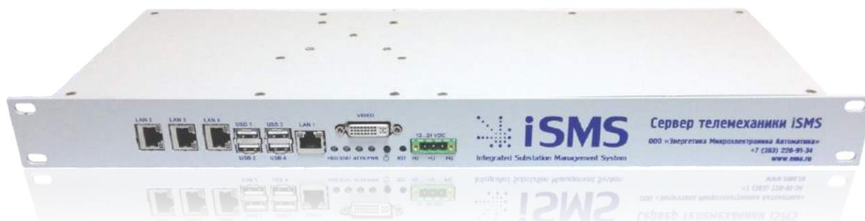
Рис. 1 – Сервер ПТК телемеханики iSMS.
